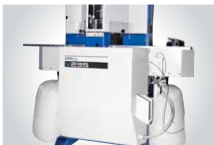
Kit 2 aspiratori Aspiratori singoli su ogni bocca: Ø 80 mm Velocità d'aspirazione: 20 m/sec Portata per ogni bocca: 320 m 3 /h Per V235 e V235FNC
